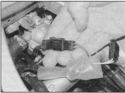
3.3a Fan wiring connector - XL600V
